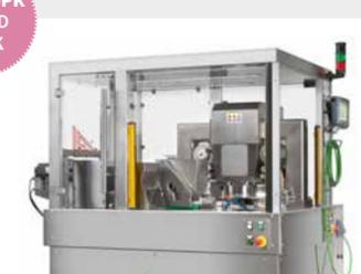
Macchina automatica adatta alla compattatura di polveri cosmetiche (ombretto, fard, cipria) in fondelli in banda stagnata/alluminio. La macchina si contraddistingue per la sua composizione modulare. Un modulo base centrale scandisce le quattro principali fasi di lavoro. È possibile aggiungere moduli optional per automatizzare al 100% la macchina.
